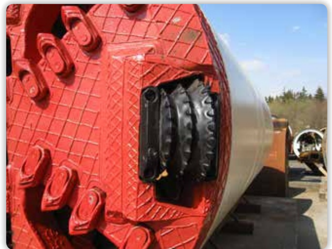
Рис.: Скобель BFM70 на станке для микротуннелинга
