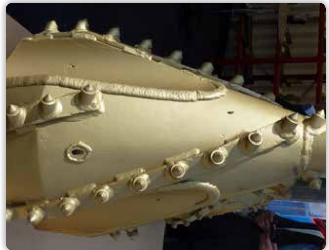
Рис.: Расширительная головка HDD с BFZ283
