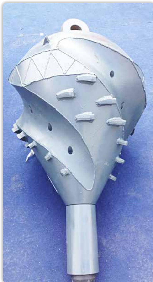
Рис.: Расширительная головка HDD с BFZ25L
